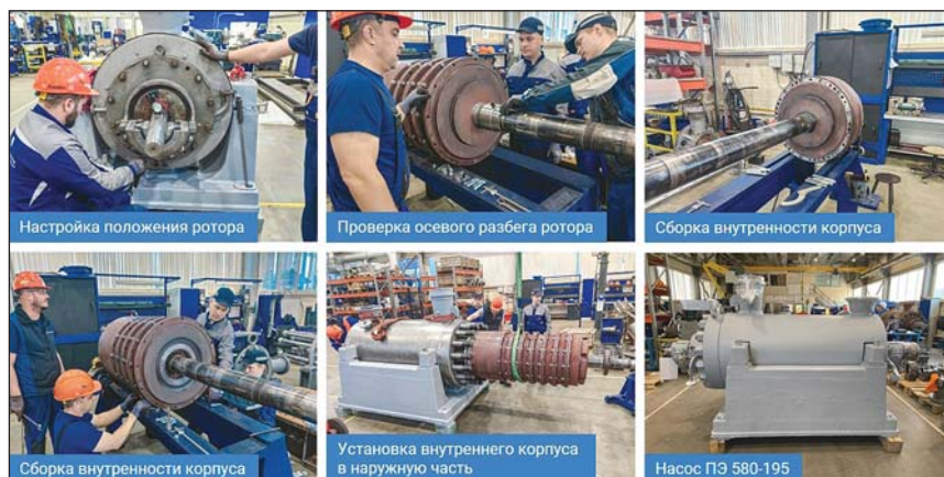
Рис. 4. Ремонт питательного насоса ПЭ 580-195
