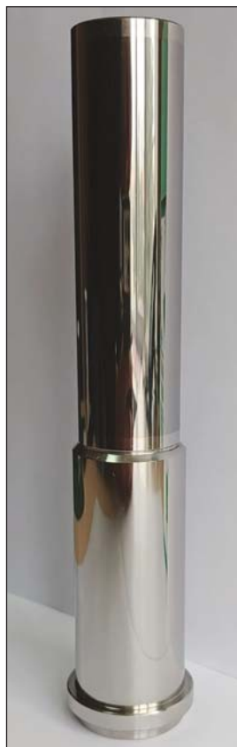
Рис. 4. Плунжер со специальным покрытием
