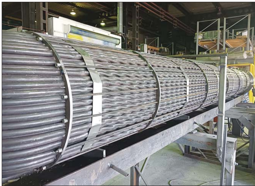
Рис. 2. Пучок с витыми трубами
