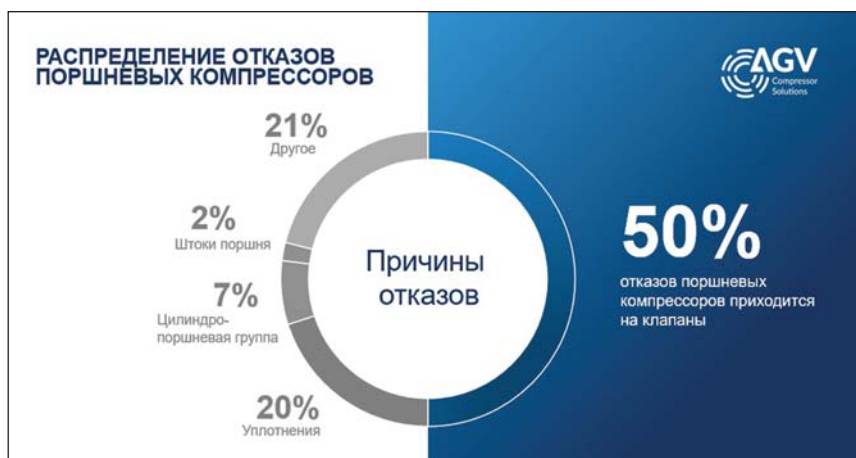
Рис. 1. Структура отказов основных узлов поршневого компрессора
