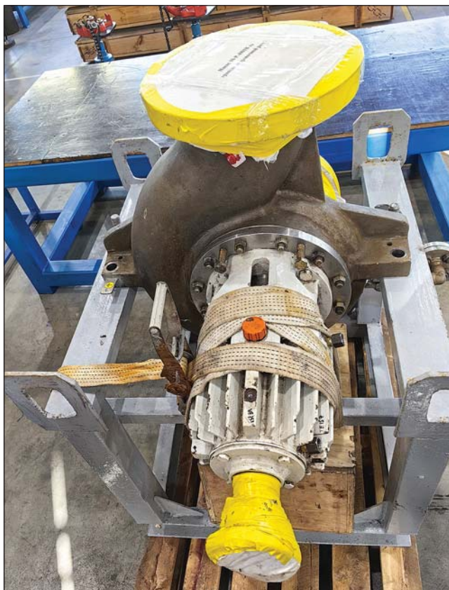
Рис. 8. Ремонт Ensival Moret PRE 200-26
