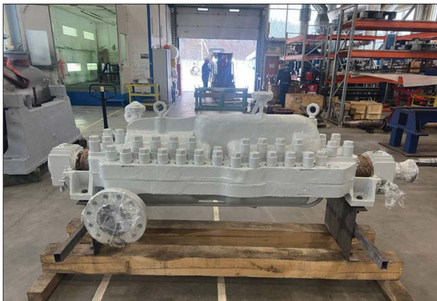
Рис. 5. Ремонт насоса типа BB3
