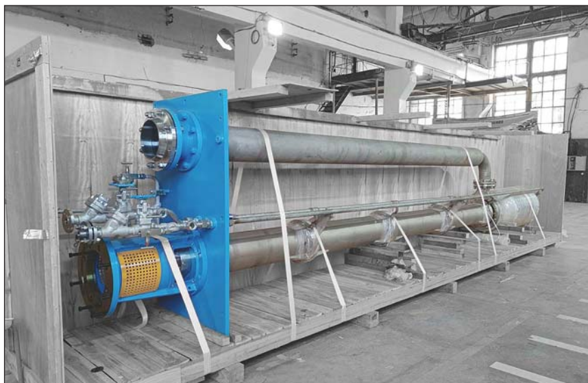
Рис. 34. Замена полупогружного насоса
