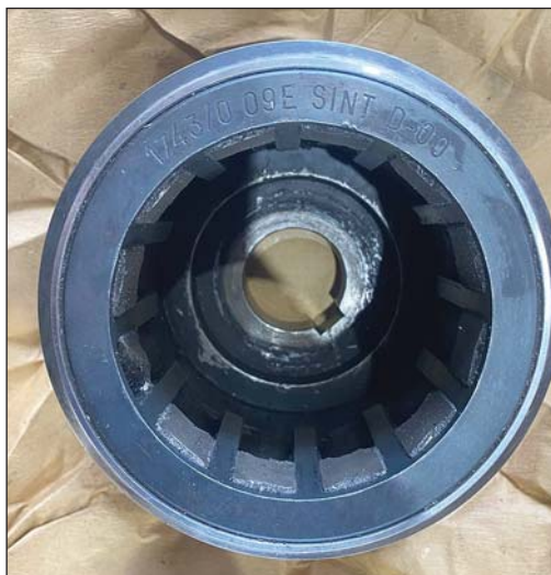
Рис. 11. Восстановление ведущей полумуфты
