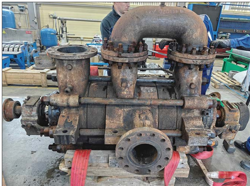
Рис. 7. Реинжиниринг насоса HGUR-200-8-64
