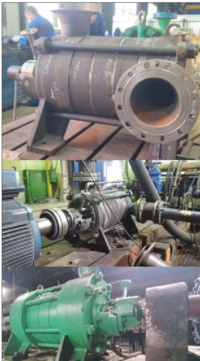
Рис. 2. Пример импортозамещения насоса ЦНС 380-130 (Украина)
